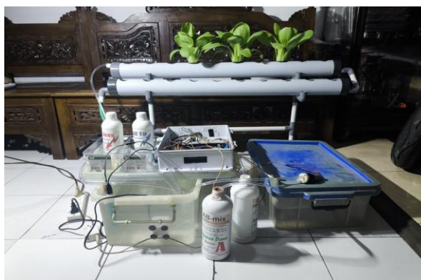
Gambar 5. Prototipe sistem monitoring dan kontrol nutrisi hidroponik berbasis Internet of Things (IoT)
