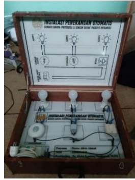
Gambar 2. Trainer Kit Berbasis Sensor cahaya dan Sensor Gerak
