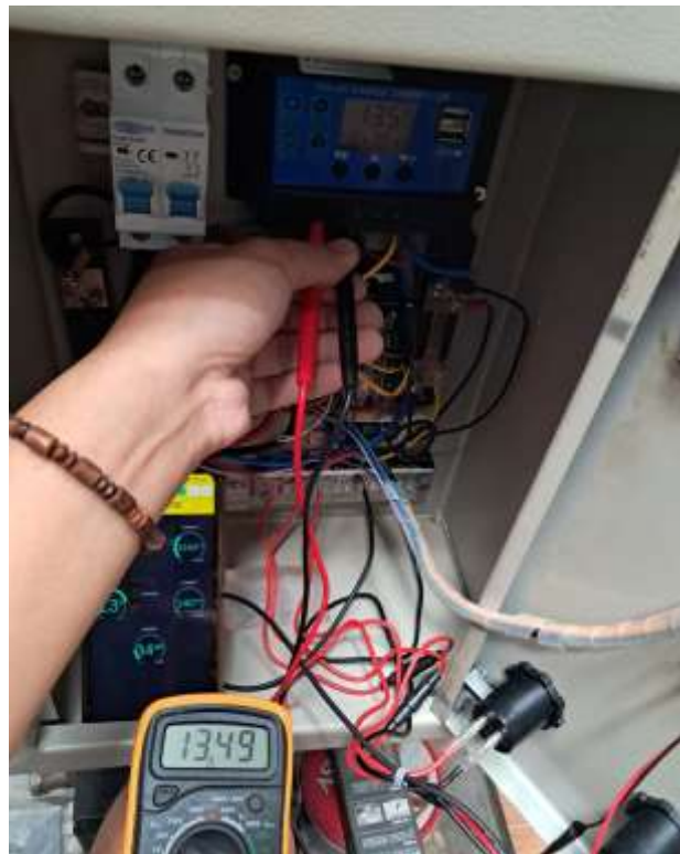
Gambar 3. 7 Pengukuran menggunakan multimeter 15 September
