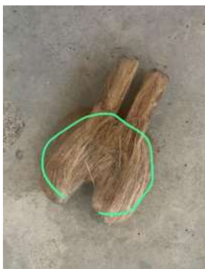
Gambar 3. 2 Permukaan sudu tidak mulus. (ditunjukkan dengan lingkaran)
