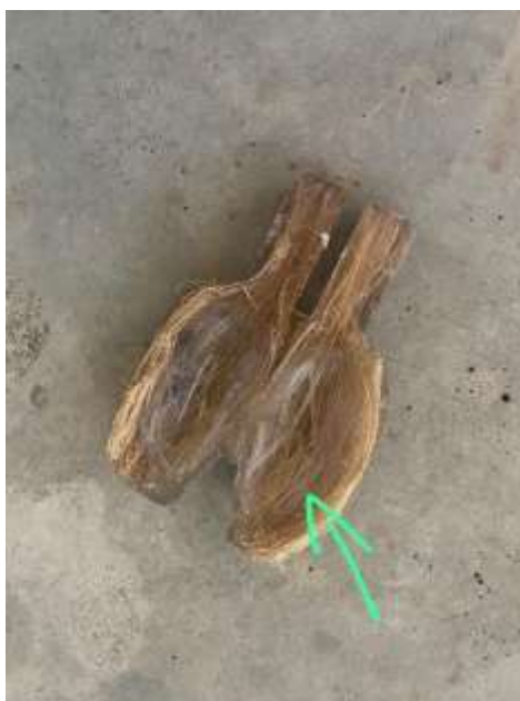
Gambar 3. 3 Keretakan pada sudu. (ditunjukkan dengan panah)
