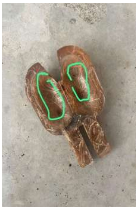
Gambar 3. 1 Udara yang terperangkap di sudu. (ditunjukkan dengan lingkaran)
