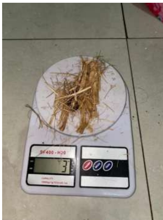
Gambar 2. 5 Jumlah Serat yang Digunakan
