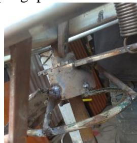
Gambar 3. Pembuatanudukan pisau atas mesin pengupas kelapa
