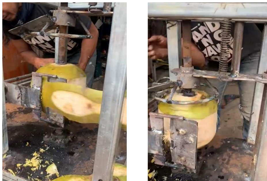
Gambar 5. Pengujian mesin pengupas kelapa
