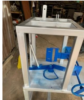
Gambar 2. Pembuatan frame mesin pengupas kelapa
